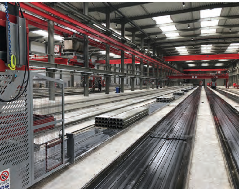
Pannelli alveolari accatastati lungo la pista dalla sbancatrice
