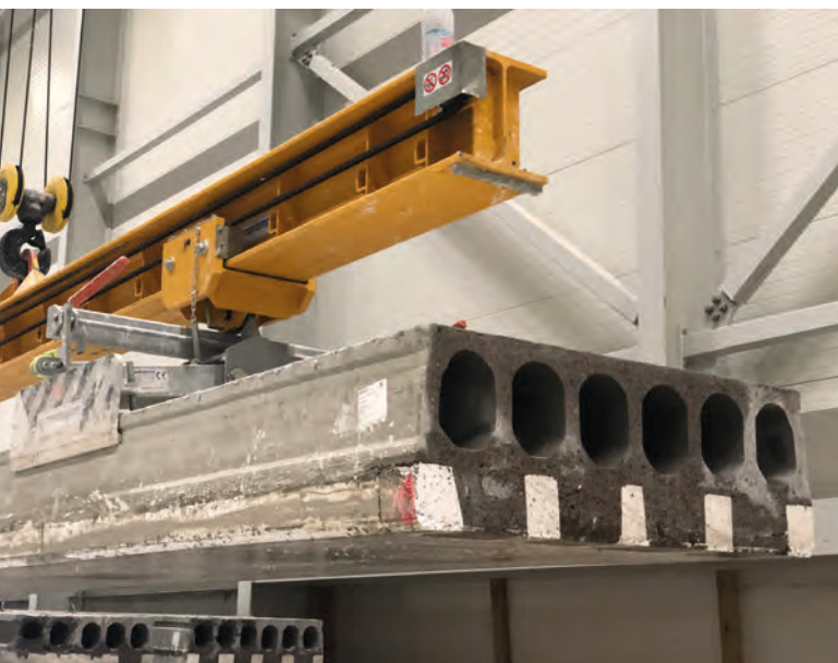
A sinistra: pannelli alveolari con isolamento, a destra: pannelli alveolari con canali specifici per il mercato olandese
