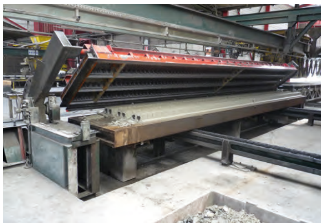
Impianto a carosello per pannelli alveolari ad armatura lenta
