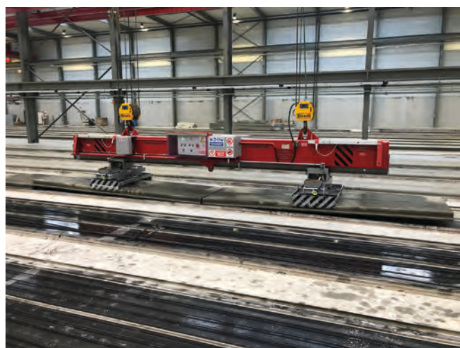
Pannelli alveolari sollevati mediante un bilancino telescopico agganciato a un carro-ponte
