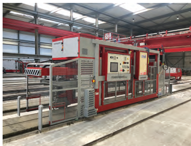
Pannelli alveolari sollevati mediante la nuova sbancatrice sviluppata dalla Nordimpianti
