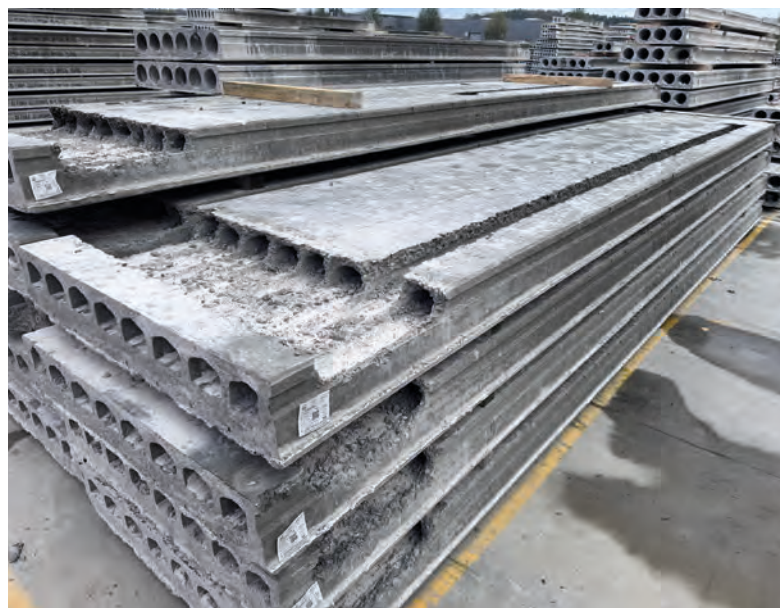
A sinistra: pannelli alveolari con isolamento, a destra: pannelli alveolari con canali specifici per il mercato olandese
